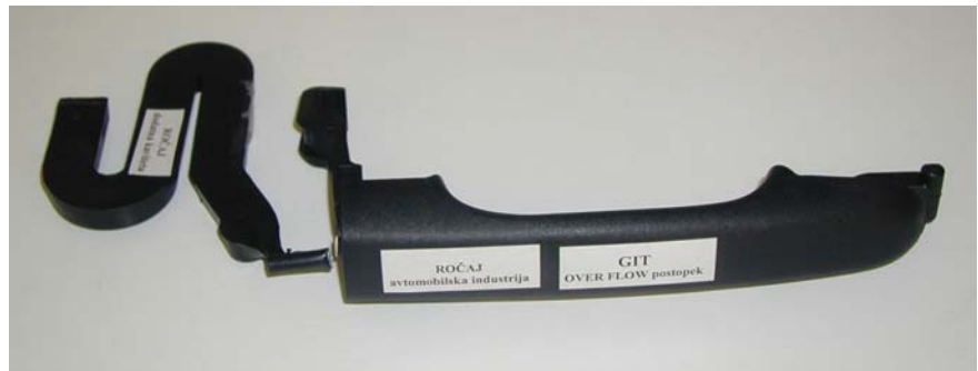
5 Izdelek, narejen z izrivanjem taline (Over-Flow) s plinom.
