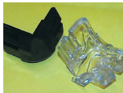
3 Odprava usedlin z izravnalnim brizganjem plina.
