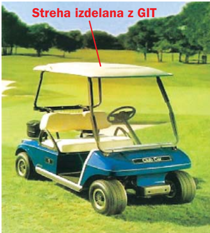
4 Streha avtomobila, izdelana s GIT tehnologijo.
